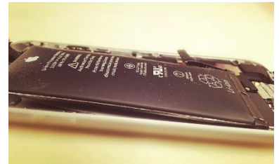
Abbildung 1: Aufgeblähter Lithium-Ionen-Akkumulator (Quelle: SGU)
